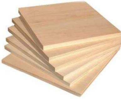
Pannelli costituiti da strati di sfogliato di Okoumé pressati con **collante fenolico o melamminico** e per questo indicati per impieghi in cui è richiesta resistenza all'umidità e agli sbalzi di temperatura. (Un test a cui sono sottoposti i materiali fabbricati con incollaggio "marino" è quello di resistere per più di 72 ore in immersione in acqua bollente). Prodotto caratterizzato da entrambe le facciate prive di imperfezioni e di colore rosa (essenza simile al faggio).
