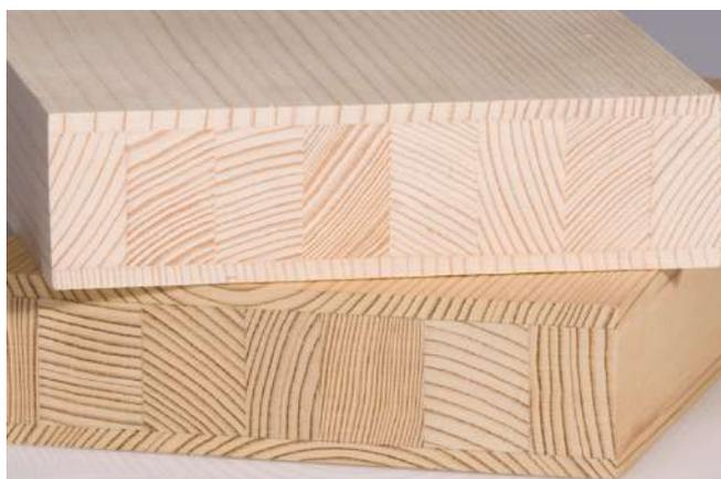
Sono liste di lamellare abete a 3 strati di **SPESORE mm48** e **qualità A/A** indicate per la costruzione di porte .
