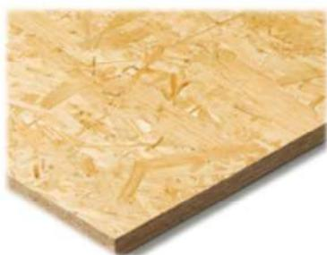
Pannelli costituiti da scaglie di tranciato di diversi tipi di legno pressate con collanti a base di resine resistenti all'acqua.
